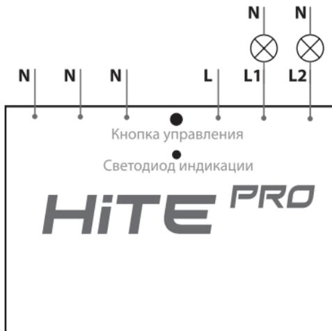
1. Разъедините цепь питания предохранителем, выключателем максимального тока или изоляционным разъединителем. Проверьте соответствующим прибором отсутствие напряжения на питающих проводах.
